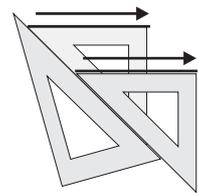
**Lámina 1.** Con la escuadra y el cartabón, trazar rectas paralelas por las divisiones indicadas. El trazado se realizará en el sentido indicado por la flecha.
