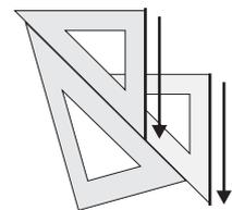
**Lámina 2.** Con la escuadra y el cartabón, trazar rectas paralelas por las divisiones indicadas. El trazado se realizará en el sentido indicado por la flecha del ejemplo.
