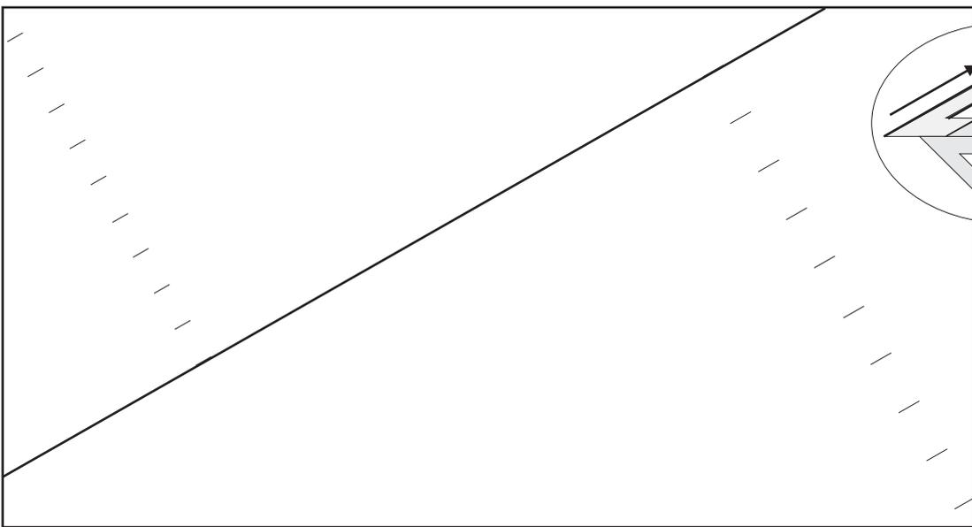
**Lámina 4.** Con la escuadra y el cartabón, trazar rectas paralelas a la línea modelo por las divisiones indicadas. El trazado se realizará en el sentido indicado por la flecha y manteniendo las plantillas según el ejemplo.
