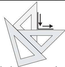
**Lámina 5.** Con la escuadra y el cartabón, trazar rectas paralelas y perpendiculares encerradas en la pauta, de forma que se repita el motivo inicial. El trazado se realizará en el sentido indicado por la flecha.
