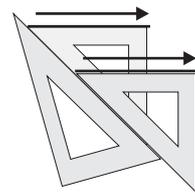
**Lámina 1.** Con la escuadra y el cartabón, trazar rectas paralelas por las divisiones indicadas. El trazado se realizará en el sentido indicado por la flecha.
